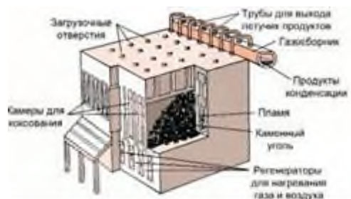
Рис. 3. Устройство коксовой печи
